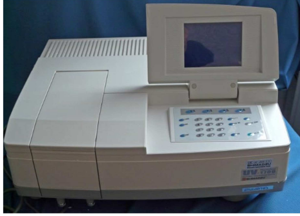
Şekil 2.8.1. Optik ölçümler için kullanılan UV-Vis Shimadzu 1700 spektrometresi.
