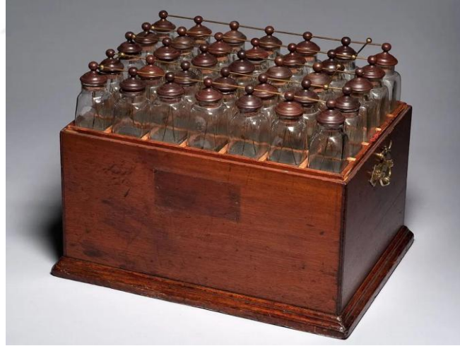
Şekil 2. 3 Benjamin Franklin’in elektrik yükü depolayan 35 adet Leyden kavanozu düzeneği
