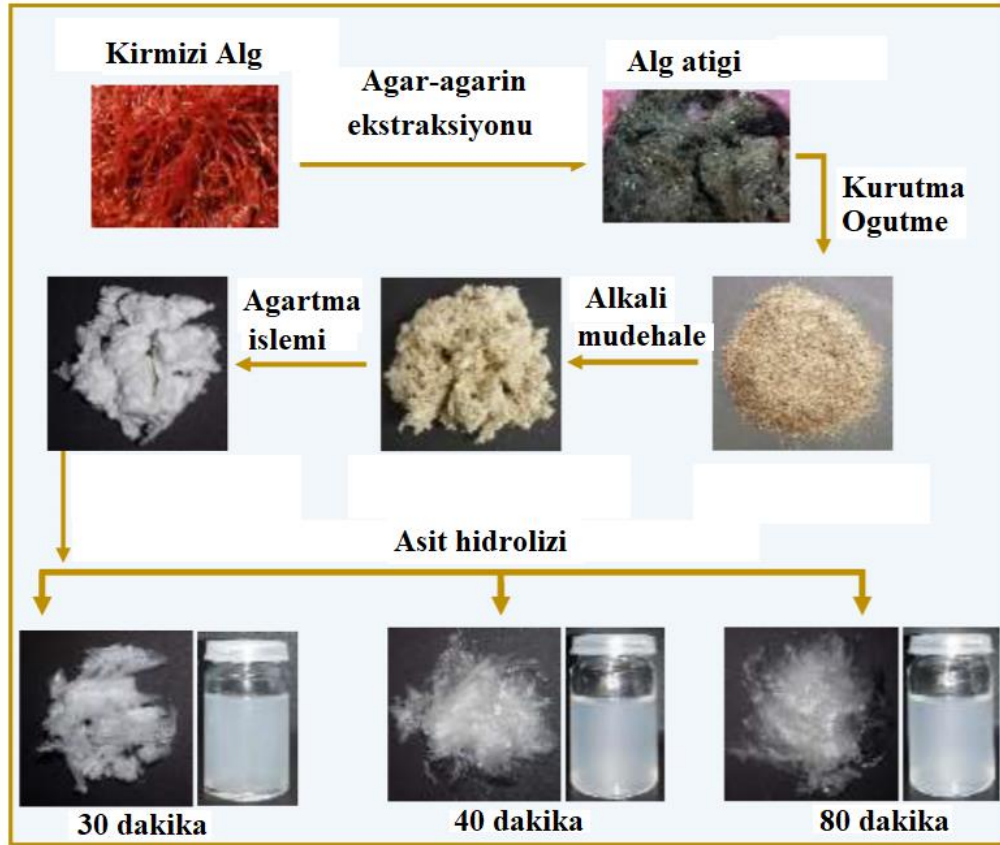
Şekil 2.25 Farklı hidroliz sürelerinde CNC ekstraksiyonunun genel adımları ve elde edilen ürünlerin dijital görüntüleri (Mounir vd., 2018)
