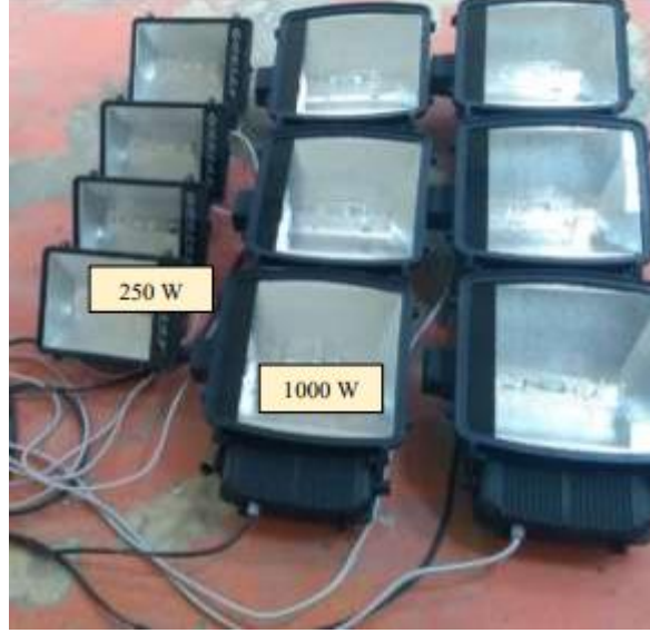
Şekil5.1 Yükleme Ünitesinde Kullanılan Projektörlerin Montaj Resmi
