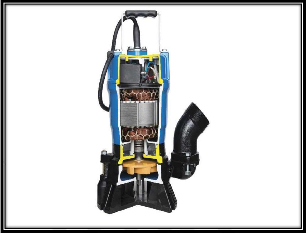
Şekil.1.22 Dalgıç pompa kesiti
