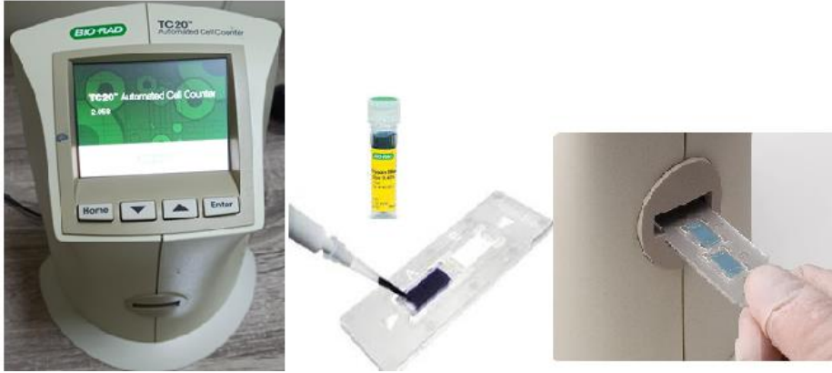
Şekil 3.2 Bio-Rad TC20 hücre sayım cihazı
