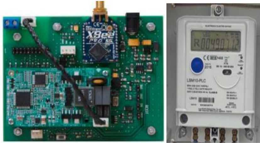
Şekil 3.4. PLC modüllü akıllı elektrik sayacı (Kocaman, 2018)
