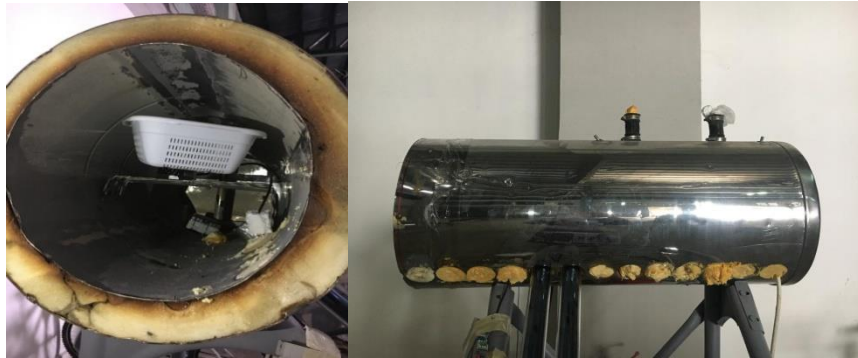
Şekil 3. 3 Kurutma kabini iç kısmı ve kabinin dış görünüşü
