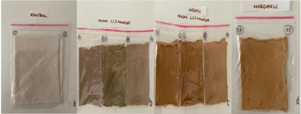
Şekil 4.6. Hekzan ekstresiyle mordanlı ve mordansız boyanan kumaş örnekleri (a:Kontrol b: Mordansız c: Mordanlı d:Sadece Mordanlı (Demir III klorid))
