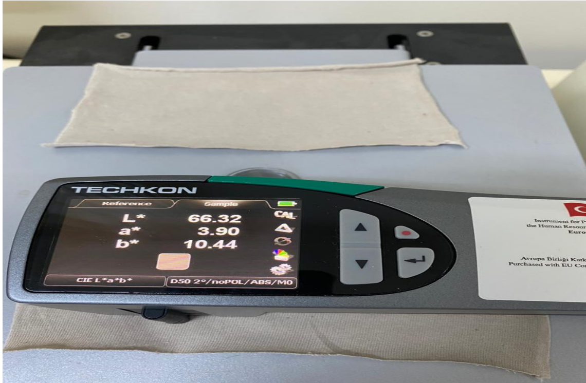
Şekil 3.7. Boyanan kumaşların L* a* b* değerlerinin Kolorimetre ile ölçülmesi
