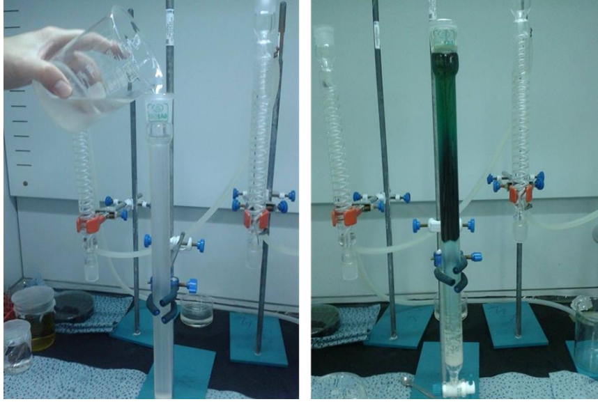
Şekil 3. 9 Ftalosiyenin kolon kromatografisi ile saflaştırma düzeneği
