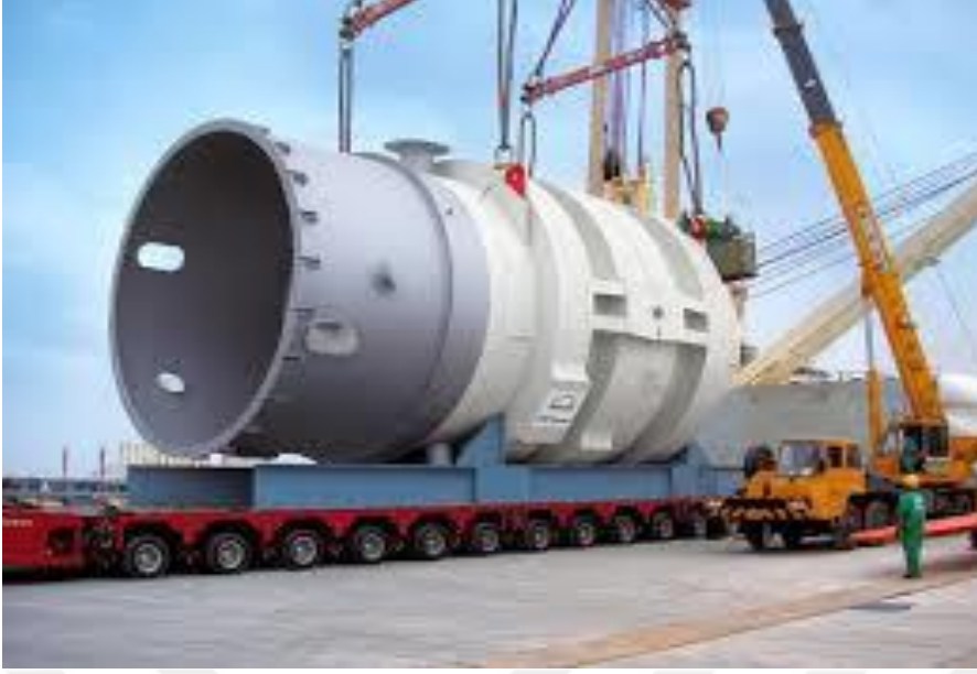
Şekil 6.7 VVER reaktör serisine ait bir basınç kabı (URL3, Anonim)
