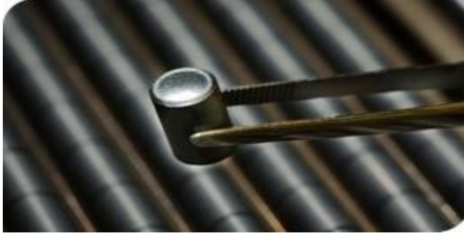
Şekil 6.2 Yakıt (uranyum) peleti (URL2, Anonim)
