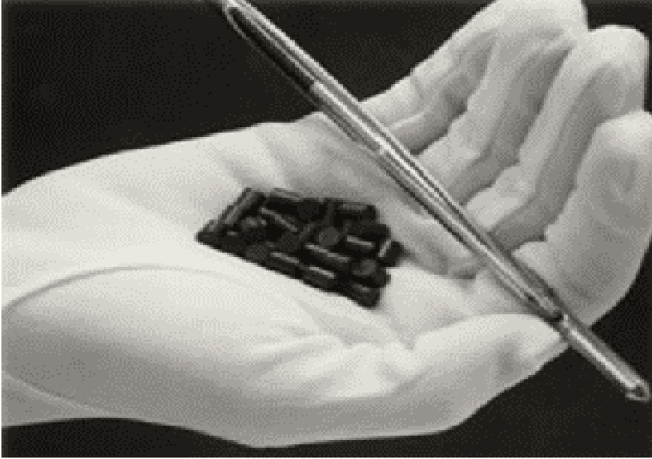
Şekil 6.3 Yakıt çubuğu (URL3, Anonim)
