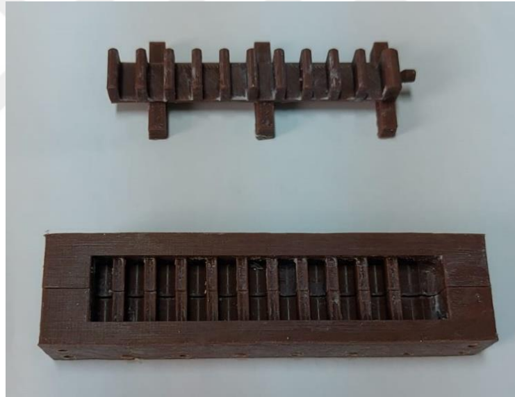
Şekil 2. 6 Esnek elektropnömatik tutucunun üretiminde kullanılan kalıplar
