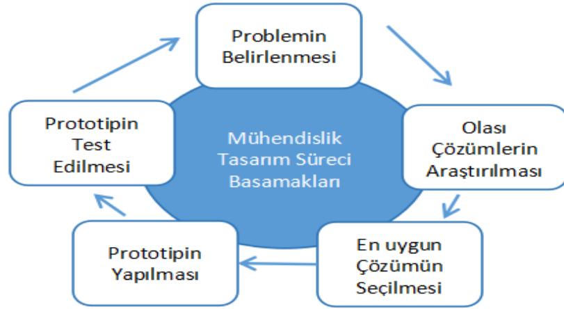
Şekil 2.4 Ortaokul 5. sınıf mühendislik tasarım süreci basamakları (Dikey yayıncılık 5. sınıf fen bilimleri ders kitabı, 2018, s. 12)
