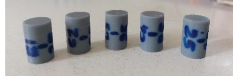
(a) %25 doluluk oranlı basma numunesi
