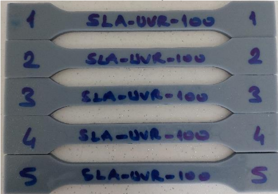
(c) %100 doluluk oranlı çekme numunesi
