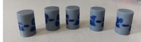
(b) %50 doluluk oranlı basma numunesi
