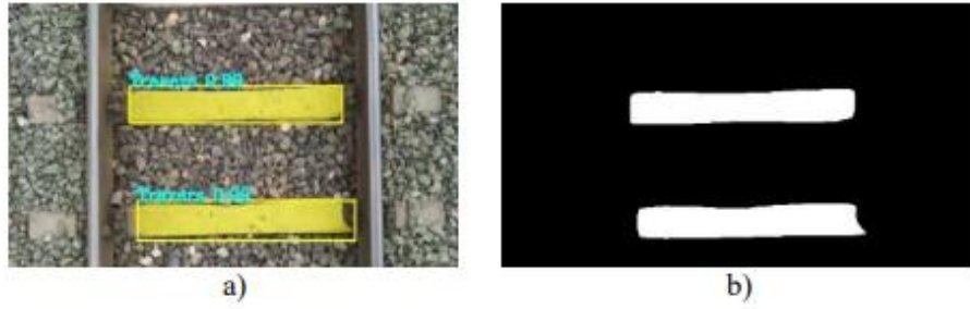
Şekil 3. 93. Mask R-CNN sonucu elde edilen görüntü a) Mask, kutu, etiket bilgisi b) İkili mask
