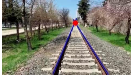
Şekil 3. 29. Derin Hough dönüşümü ile rayların ve ufuk noktasının tespiti
