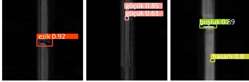
Şekil 4. 53. YOLOv5m alt mimarisinin test sonuçları
