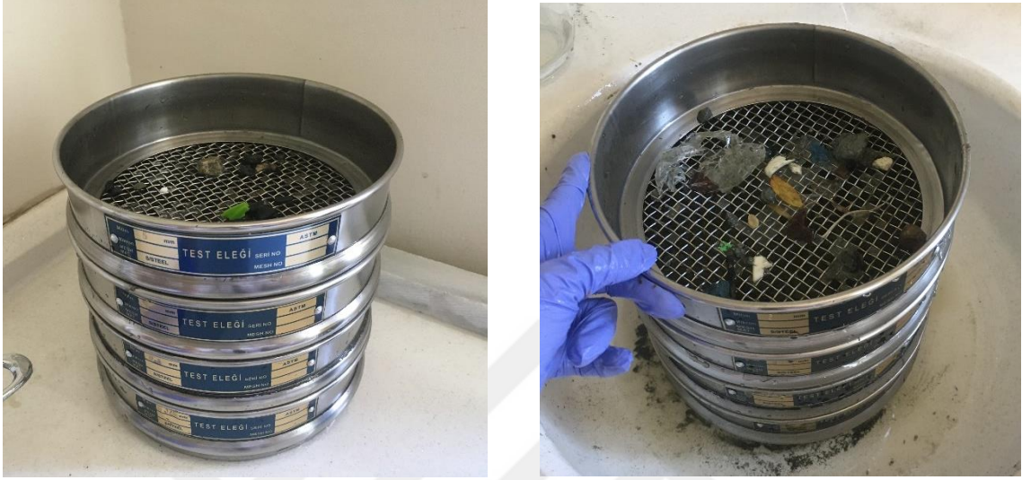
Şekil 3. 2 Örnekleri boyutlarına göre kategorize etmek için oluşturulan dört aşamalı elek sistemi
